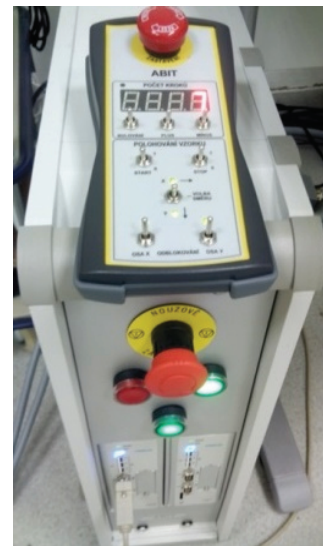
Fig. 3 Device to load the samples in thermal chamber, ÚJV Řež, a.s.
